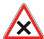
Intersection où le conducteur est tenu de céder le passage aux véhicules débouchant de la ou des routes situées à sa droite
